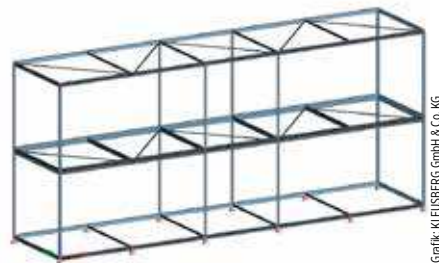
Statisches Analysemodell einer Konstruktion mit Stahlrahmenmodulen
