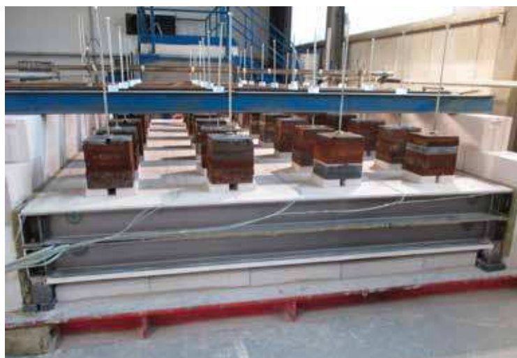
Moduldecke vor dem Brandversuch beim DIBT
