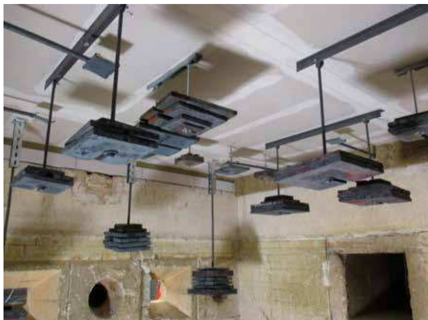
Moduldecke vor dem Brandversuch beim DIBT
