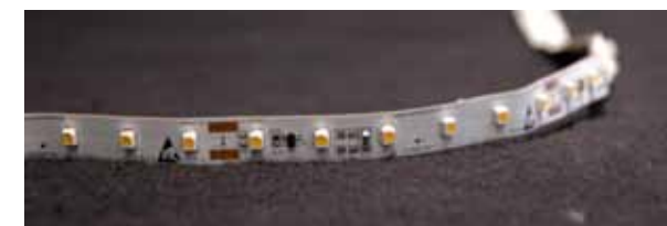
LED Stripes kommen aufgrund ihrer Konstruktion und Leistungsdichte ohne Kühlung aus (Foto: DIAL)
