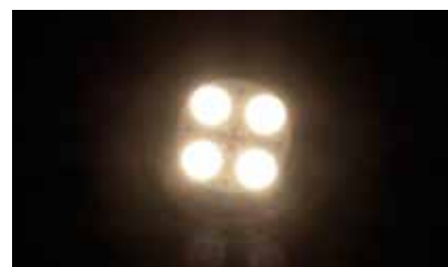
LEDs mit verschiedenen Farbtemperaturen sorgen für eine wärmere Lichtfarbe beim Dimmen (Quelle: DIAL)
