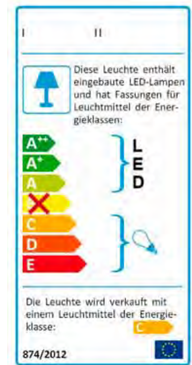
Etikettierung einer Leuchte mit nicht austauschbaren LED-Modulen, und auch Fassungen für vom Nutzer austauschbaren Lampen (Quelle: EU-Verordnung 874/2012)
