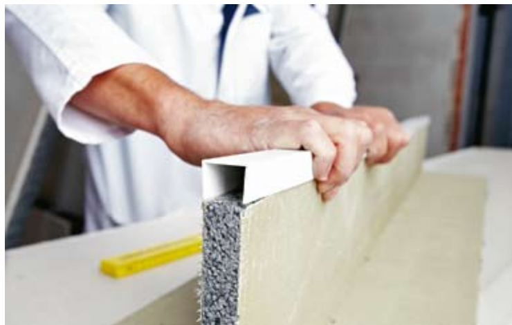
Einen bauphysikalisch sicheren und optisch einwandfreien Übergang zwischen Laibungsdämmplatte und Fensterrahmen gewährleistet bei der RigiTherm-Lösung das ThermoProfil. Die U-förmige Kunststoffleiste wird auf die Außenkante der Platte gesteckt, die später den Fensterrahmen berührt
